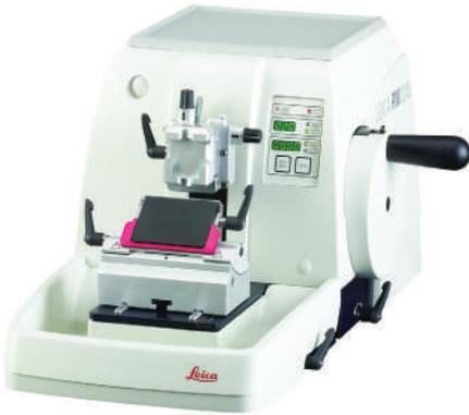
**جهاز الميكروتوم:** جهاز يستخدم لتحضير الشرائح حيث يقوم بتقطيع العينات السميكة إلى عينات رقيقة جداً. ينفذ الضوء من خلالها.
