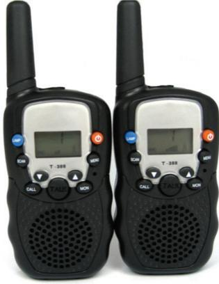
من أشهر الأنظمة التي تستخدم هذا الأسلوب أجهزة اضغط للتكلم (push to talk)، كل طرف يستطيع التكلم والسماع، ولكن ليس بنفس الوقت، لذلك يوجد مفتاح عند الضغط عليه تستطيع التكلم ولا يمكنك سماع الطرف الآخر وعند إزالة الضغط عنه تستطيع أن تسمع دون أن تتكلم .
