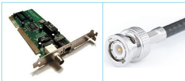
يستخدم هذا الكابل عند أطرافه توصيلات من نوع BNC توضح الصور المجاورة هذه التوصيلات على كل من الكابل وكرت الشبكة .
