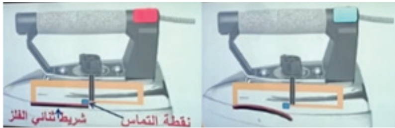
الثرموستات في دارة المكواة الكهربائية
